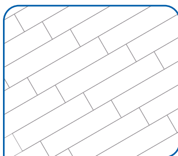
Colocación regular (sep. máx 20 cm.)
