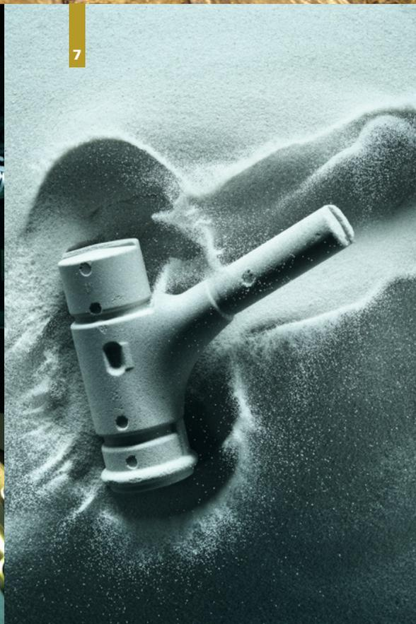
**5** – Die Basis ist Messing, das in Barren angeliefert wird. **6** – Armaturen-Grundform aus Messing. **7** – Der geschossene Sandkern erzeugt das Innenleben der Armatur. Er wird von Hand in die Kokille eingelegt und mit geschmolzenem Messing gegossen – so entsteht die Armaturen-Grundform.
